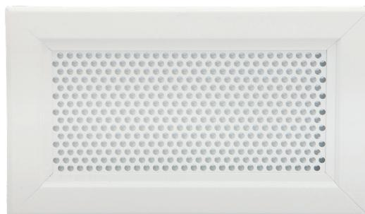
Diffusore a dislocamento per installazione a parete con pannello frontale forellinato al 50%, in acciaio verniciato bianco RAL 9010, dotato di equalizzatore posteriore e clips per facilitare l'operazione di passaggio sul plenum.
