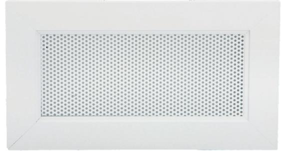
Diffusore a dislocamento per installazione a parete con pannello frontale micro-forellinato e cornice in alluminio estruso anodizzato, il tutto verniciato bianco RAL 9010, completo di clips per facilitare l'operazione di issaggio sul plenum.
